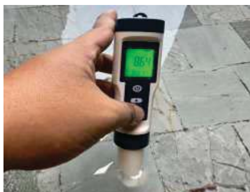
ภาพที่ 3.5.3-2 การตรวจวัด pH, \text{Cl}_2 สระว่ายน้ำ
